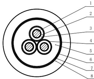
1-动力线芯导体；2-导体屏蔽；3-绝缘；4-绝缘屏蔽（兼作接地线）；
