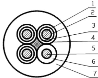
1-动力线芯导体；2-绝缘；3-填芯；4-半导体屏蔽；5-地线芯；
