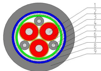
1-动力线芯导体 2-动力线芯绝缘 3-动力线芯绝缘屏蔽 4-地线芯导体
