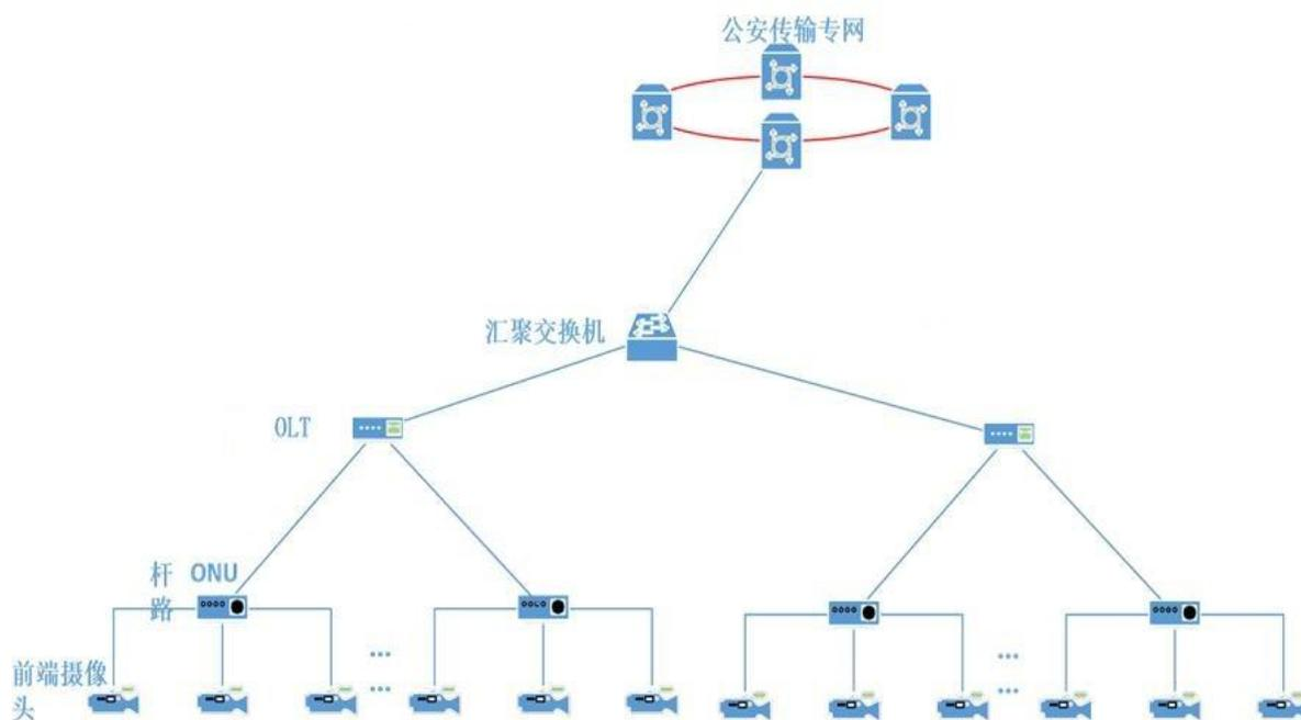
建议在保证网络线路安全的前提下，在不影响视频流传输效果的前提下，OLT、汇聚交换机可放置运营商网络节点机房，不对网络架构做强制要求。
