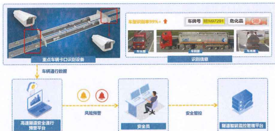
图 3-4 设备安装及数据流转架构图
